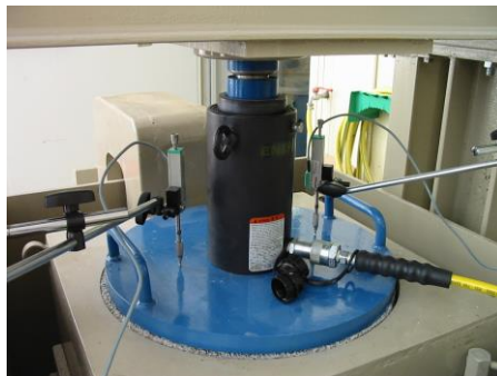
Φωτ. 12.2.1 Μεγάλου μεγέθους συσκευή άμεσης διάτμησης που χρησιμοποιήθηκε για τη μέτρηση της διατμητικής αντοχής των χονδροκόκκων υλικών του οπλισμένου επιχώματος του Κέντρου Πολιτισμού του Ιδρύματος Σταύρος Νιάρχος
