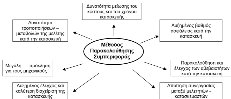
Σχήμα 1. Πλεονεκτήματα της μεθόδου παρακολούθησης συμπεριφοράς (Nicholson κ.α. 1997) Figure 1. Advantages of the observational method (Nicholson et. al. 1997)
