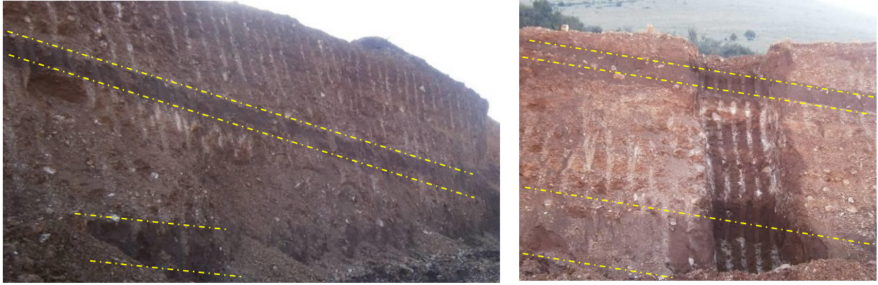
Σχήμα 5. Αποψη αργιλικών ενστρώσεων σε δοκιμαστικές τομές επί του πρανούς. Figure 5. View of clay interlayers within trial excavations of the slope.
