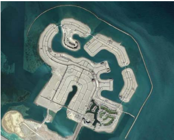
Φωτογραφία 27. Δορυφορική άποψη τεχνητού νησιού Amwaj (Μπαχρέιν) κατασκευασμένο με χρήση γεωσωλήνων. Photograph 27. Satellite view of Amwaj artificial island (Bahrain) constructed using geotubes (Fouler et. al 2002b).
