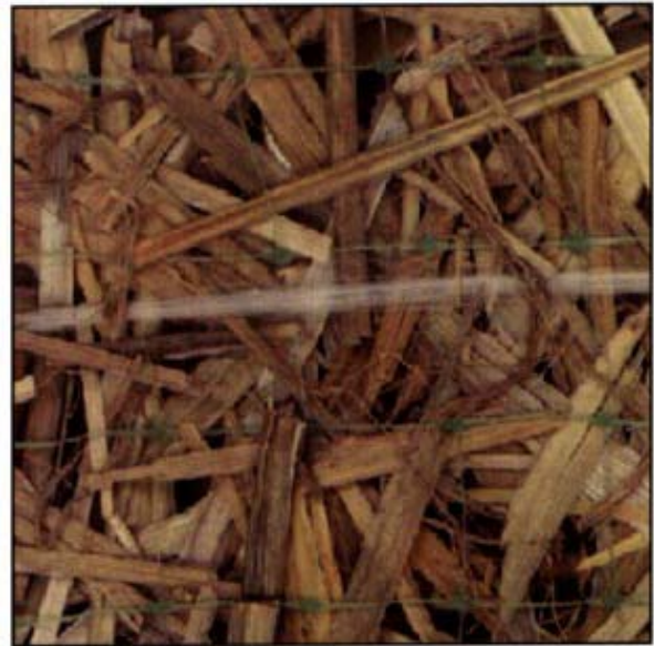
Φωτογραφία 11. Αντιδιαβρωτικός τάπητας από άχυρο επί γεωπλέγματος Photograph 11. Erosion control blanket consisting of straw bonded on a geogrid (TerraGuard™)
