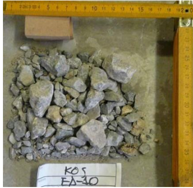
Φωτογραφία 2. Δείγματα από ασύνδετο και με ενδείξεις σταθεροποίησης αμμοχάλικο base που λήφθηκαν από τις εξεταζόμενες θέσεις δοκιμών.
