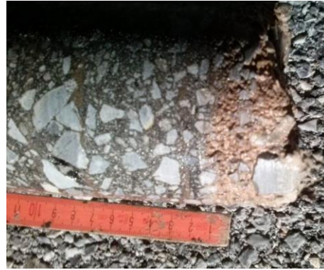
Φωτογραφία 2. Δείγματα από ασύνδετο και με ενδείξεις σταθεροποίησης αμμοχάλικο base που λήφθηκαν από τις εξεταζόμενες θέσεις δοκιμών.
